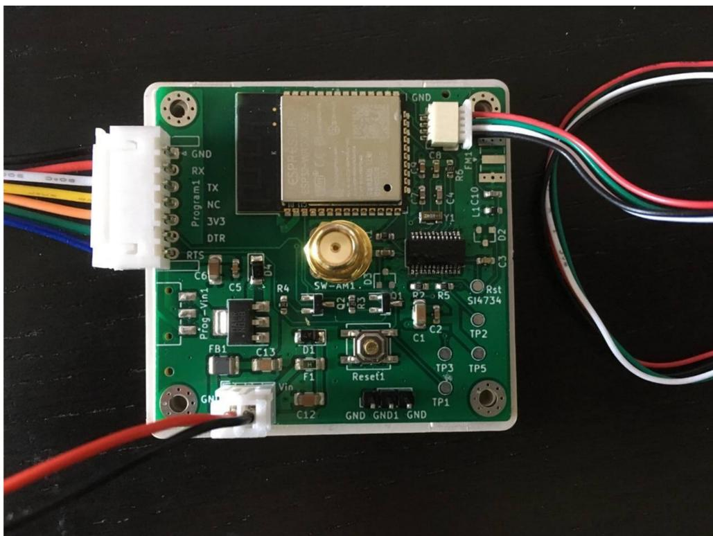
Selbst entwickeltes Board mit ESP32 Mikrocontroller, SI4734 SDR und NMEA GPS Anschluss.
